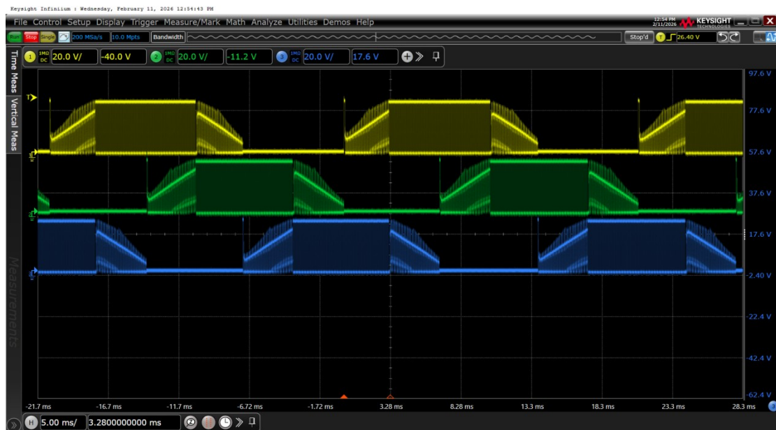
上图低速驱动参考波形（梯形波）
